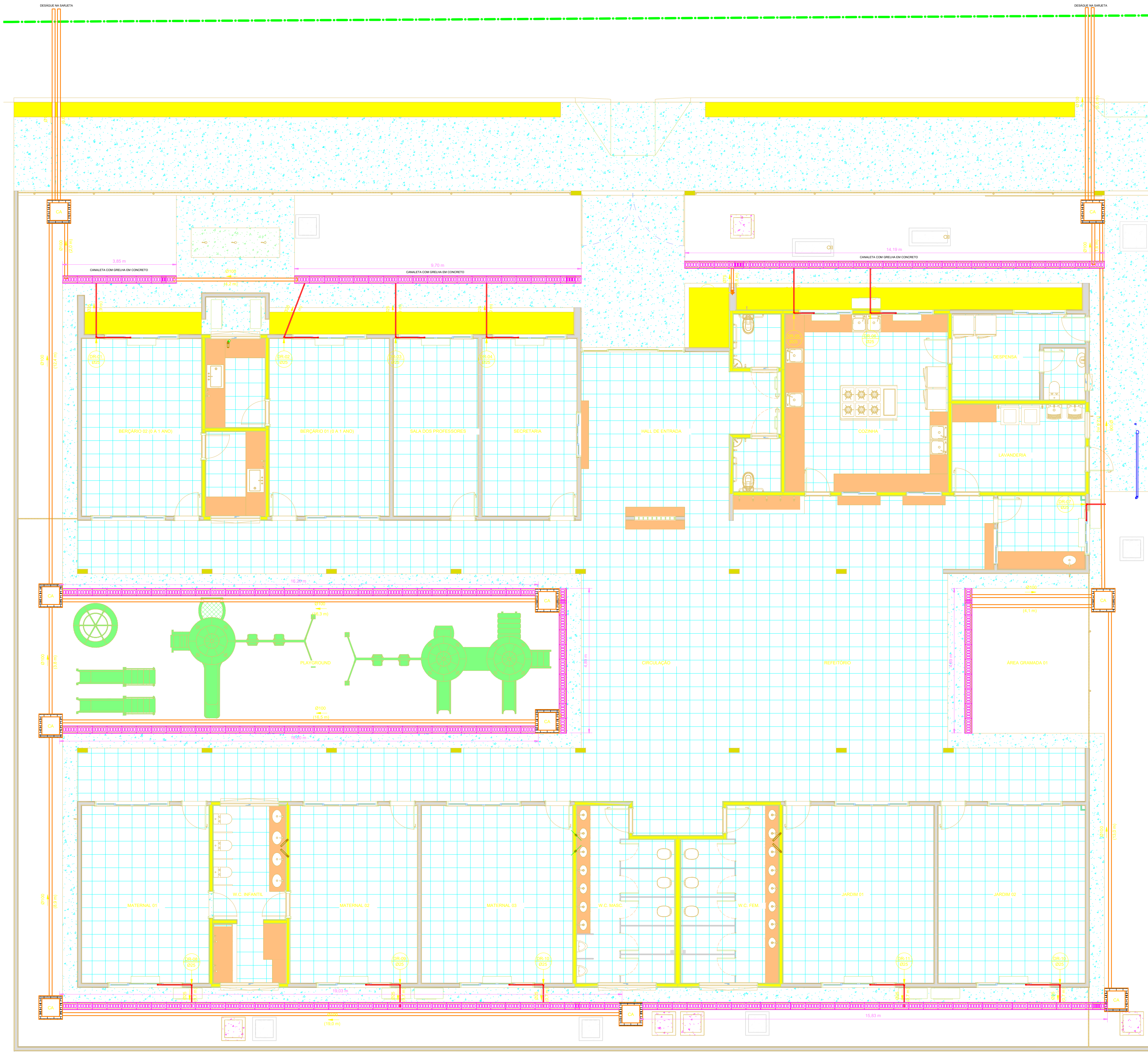
1 DRENAGEM PLUVIAL E DRENO DE AR CONDICINADO 1 : 70
